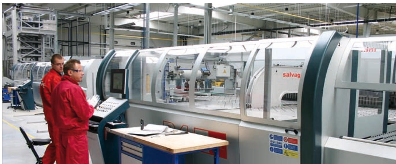
Автоматическая штамповочно-загибающая линия для обработки жести
