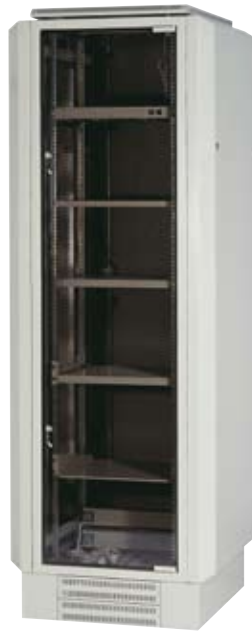
Szafa SZB z głębokimi osłonami bocznymi [F] Konstrukcja tej szafy jest oparta na szkielecie o wymiarach 600 x 800 mm, a poprzez zastosowanie głębokich osłon uzyskujemy szafę o szerokości 800 mm.
