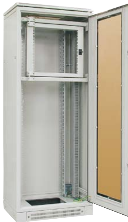
Szafa SZB o wysokości użytkowej 42 U i szerokości 800 mm z ramą obrotową 10 U - wykonanie specjalne (szczegółowy opis ram obrotowych na str. 78).
