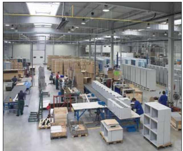
Montaż obudów teleinformatycznych
