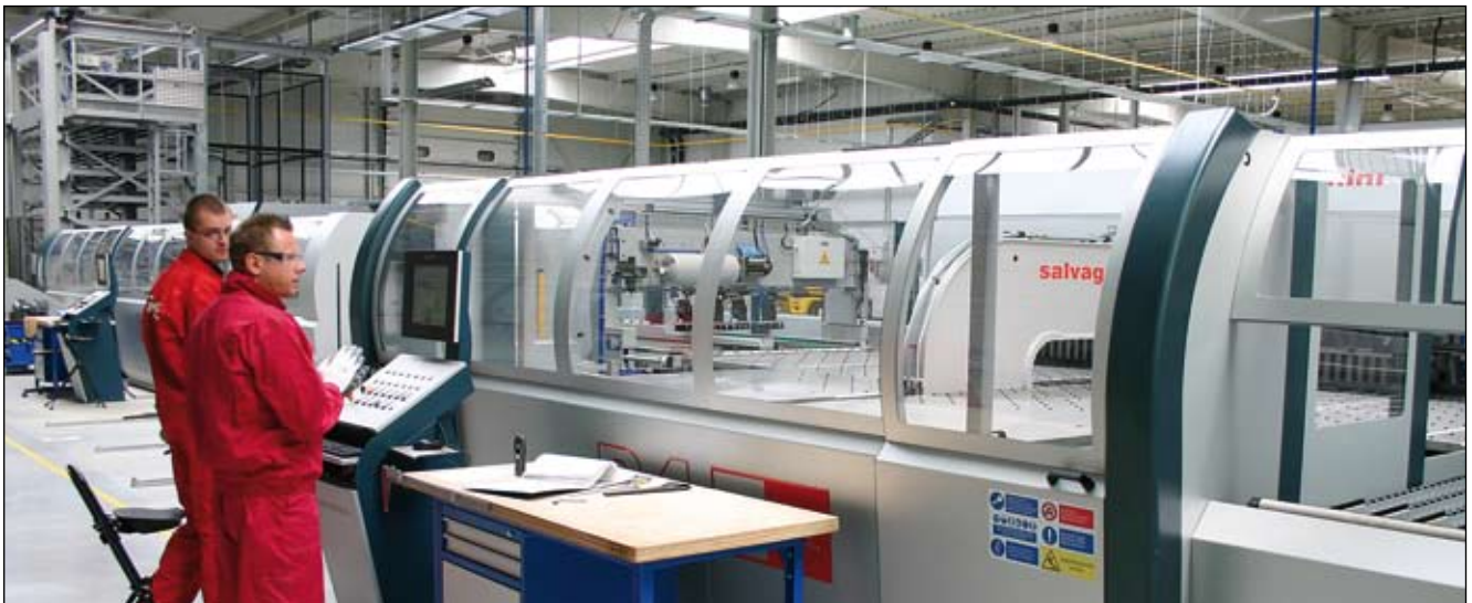
Automatyczna linia wykrawająco-gnąca do obróbki blach
