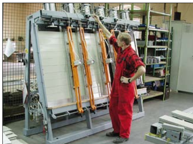
Montaż konstrukcji ścian szaf zewnętrznych z zaciskanych profili aluminiowych
