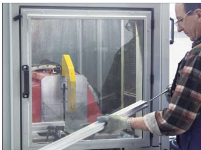
Cięcie profili aluminiowych wykorzystywanych do budowy szkieletów szaf zewnętrznych
