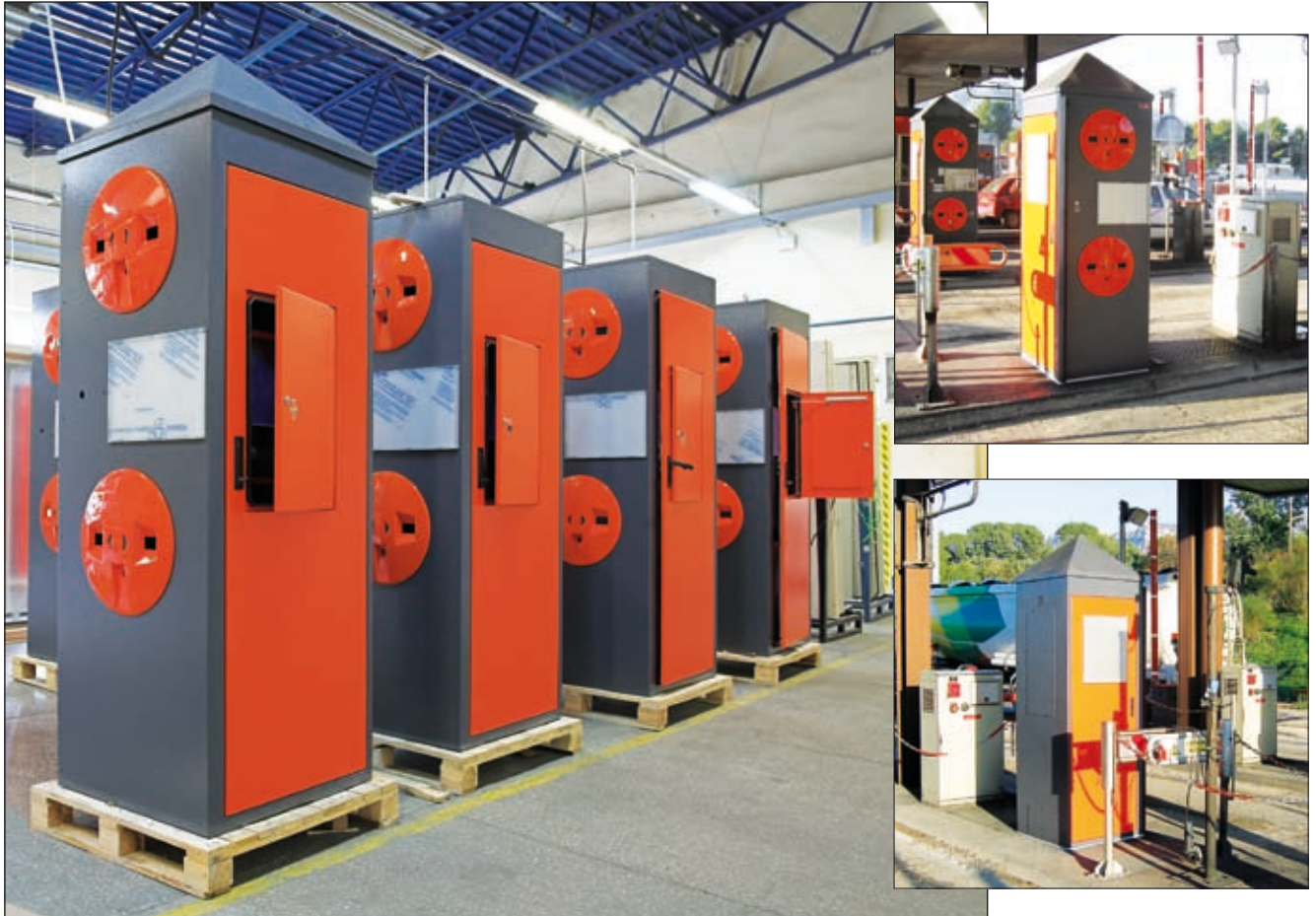
Bramki autostradowe wyprodukowane w ramach kooperacji dla firmy Ascom MultiToll Solutions SAS z Francji. W zakres dostawy wchodziło wykonanie obudów wraz z montażem elektrycznym. Bramki zamontowano przy wjeździe na autostradę na południu Francji.
