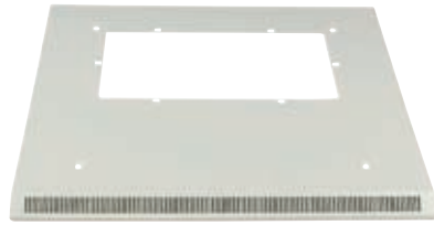
[4] Dach z otworem 380 x 210 mm pod zaślepkę o wym. 420 x 250 mm (zaślepkę należy zamawiać osobno - patrz str. 82-83)
