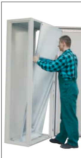
Montageplatte wird von vorn auf Gleit-schienen in den Schrank hineingescho-ben und an 4 Punkten fixiert.
