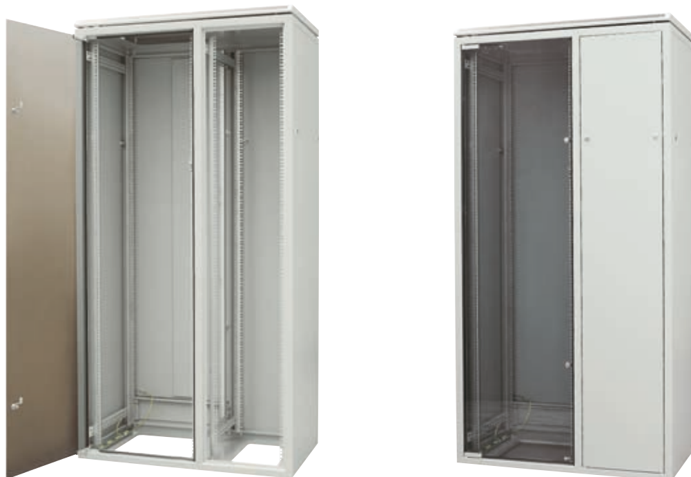
1000 mm breiter Schrank SZB mit zwei Kammern. Die linke Kammer ist mit 19"-Profilschienen ausgestattet, die rechte mit Tragwinkeln im 300 mm Abstand.
