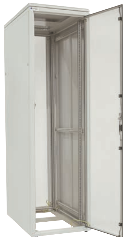
Schrank SZB SE 42 HE, 600x1000 mm, Farbe RAL 7035, Tür mit Perforation Typ C, Nivellierfüßen, 2 Paare Profilschienen - Katalognummer: WZ-SZBSE-006-5711-11-0000-2-011
