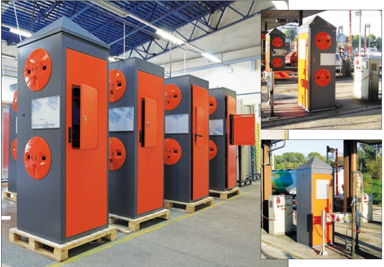
Mautstationen hergestellt im Rahmen der Zusammenarbeit für die Firma Ascom MultiToll Solutions SAS aus Frankreich. Im Lieferumfang ist die Ausführung der Schränke mit elektrischer Montage enthalten. Die Mautstationen wurden an der Auffahrt auf die Autobahn im Süden Frankreichs montiert.
