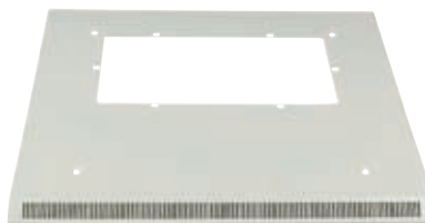
[4] Toit avec une ouverture de 380 x 210 mm pour la plaque d'obturation à dimensions 420 x 250 mm (la plaque d'obturation est fournie sur commande à part - voir les pages 82-83)
