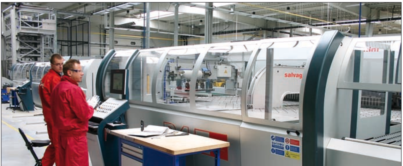
Panneauteuse-plieruse numérique pour l'usinage de la tôle
