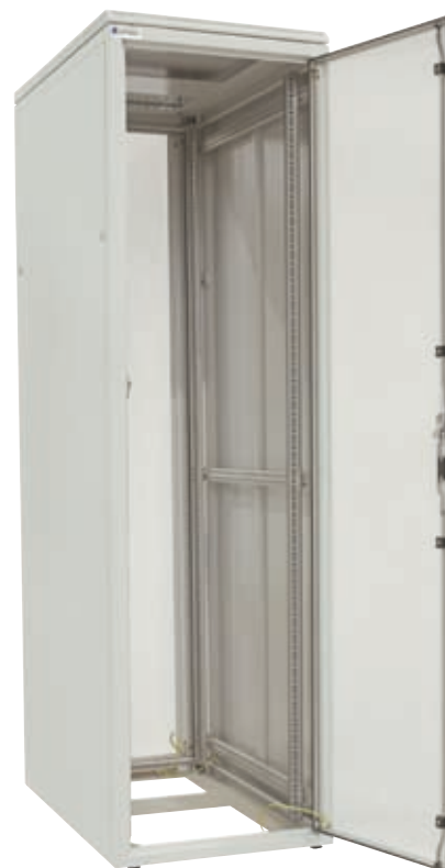
Baie SZB SE 42 U, 600x1000 mm, couleur RAL 7035, pieds réglables, porte en acier avec perforation type C, 2 paires de montants écartés de 19" - référence de catalogue WZ-SZBSE-006-5711-11-0000-2-011
