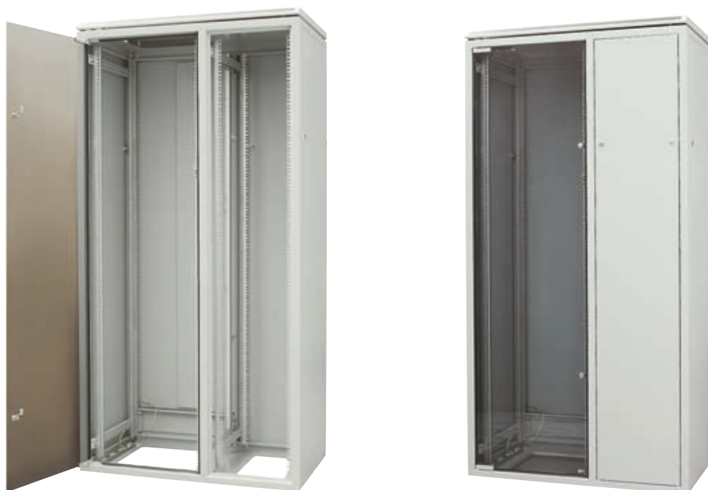
Baie SZB de 1000 mm de largeur à deux sections. La partie gauche de la baie est équipée des montants porteurs écartés à distance de 19". La partie droite est munie des cornières porteuses L écartées à distance de 300 mm.
