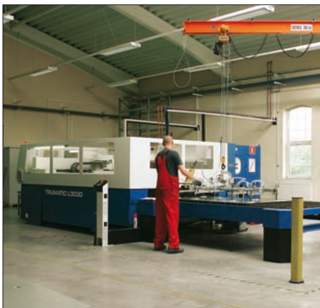
Découpe de tôles à faisceau laser
