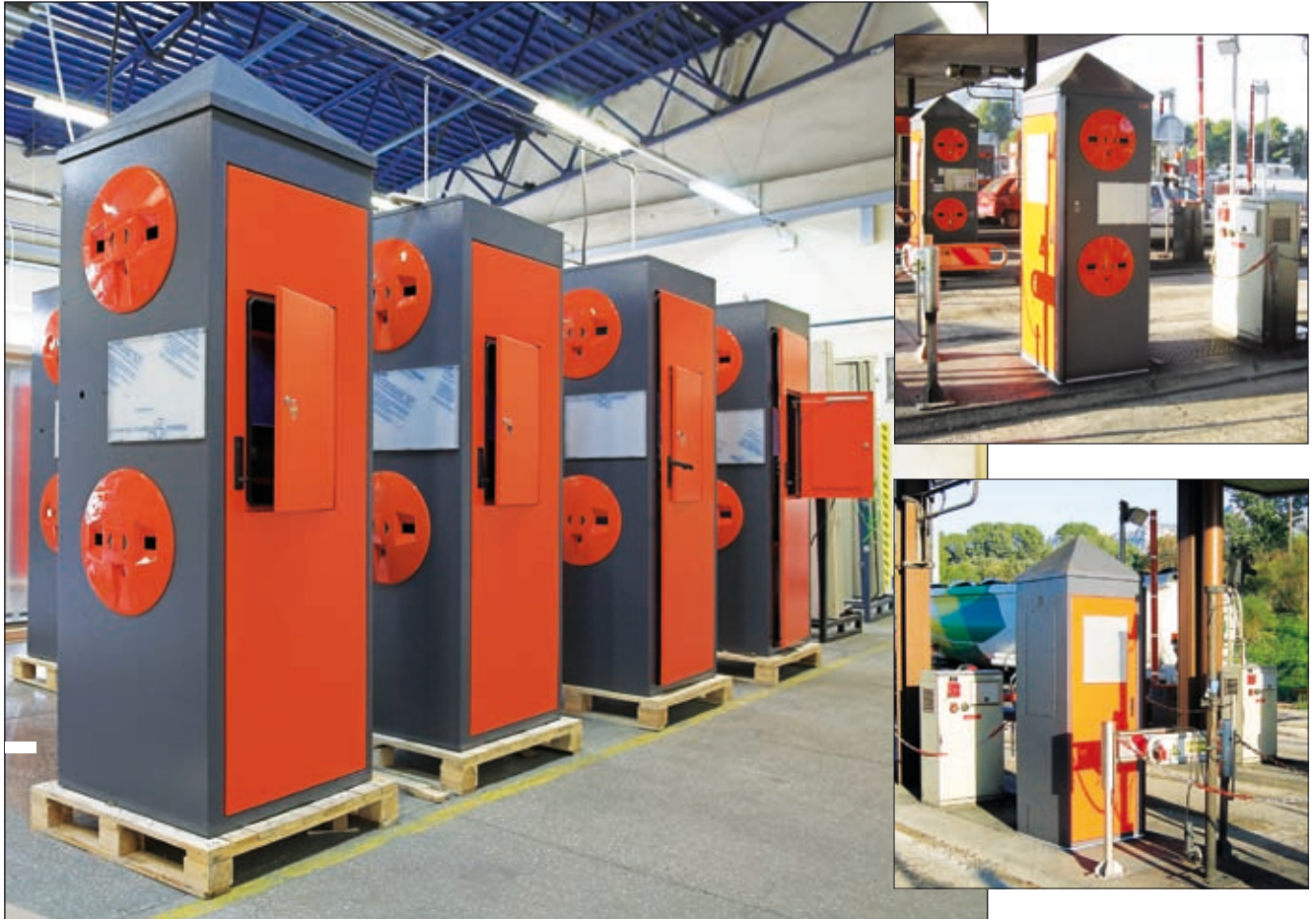
Stations de péage d'autoroute produites dans le cadre de coopération pour Ascom MultiToll Solutions, une SAS française. La fourniture comprenait la production des armoires et leur installation électrique. Les stations de péage ont été installées à l'entrée d'une autoroute dans le Sud de la France.
