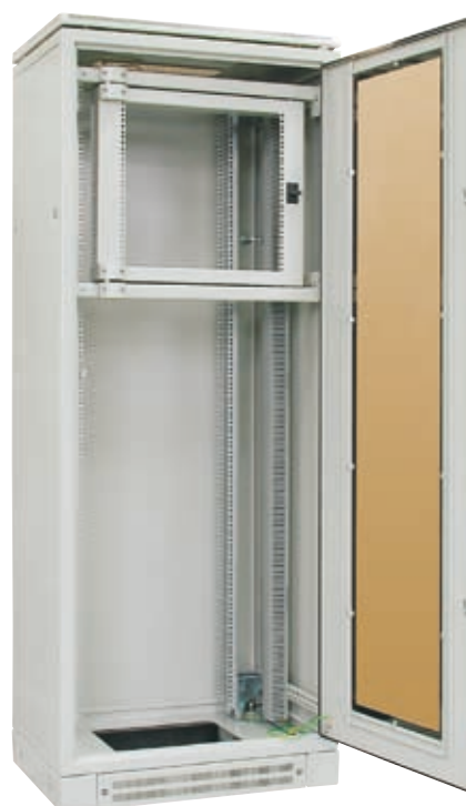
Baie SZB de hauteur utile de 42 U et de largeur de 800 mm avec cadre pivotant 10 U (la description détaillée des cadres pivotants à la page 91)
