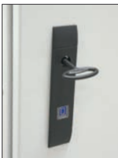
Замок без ручки с вкладышем типа «doppelbart»
