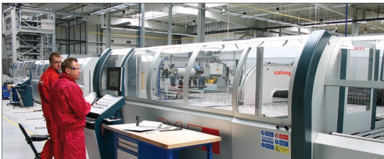
Автоматическая штамповочно-загибающая линия для обработки жести
