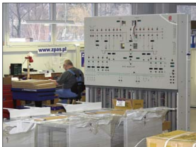
Montaż tablic mozaikowych
